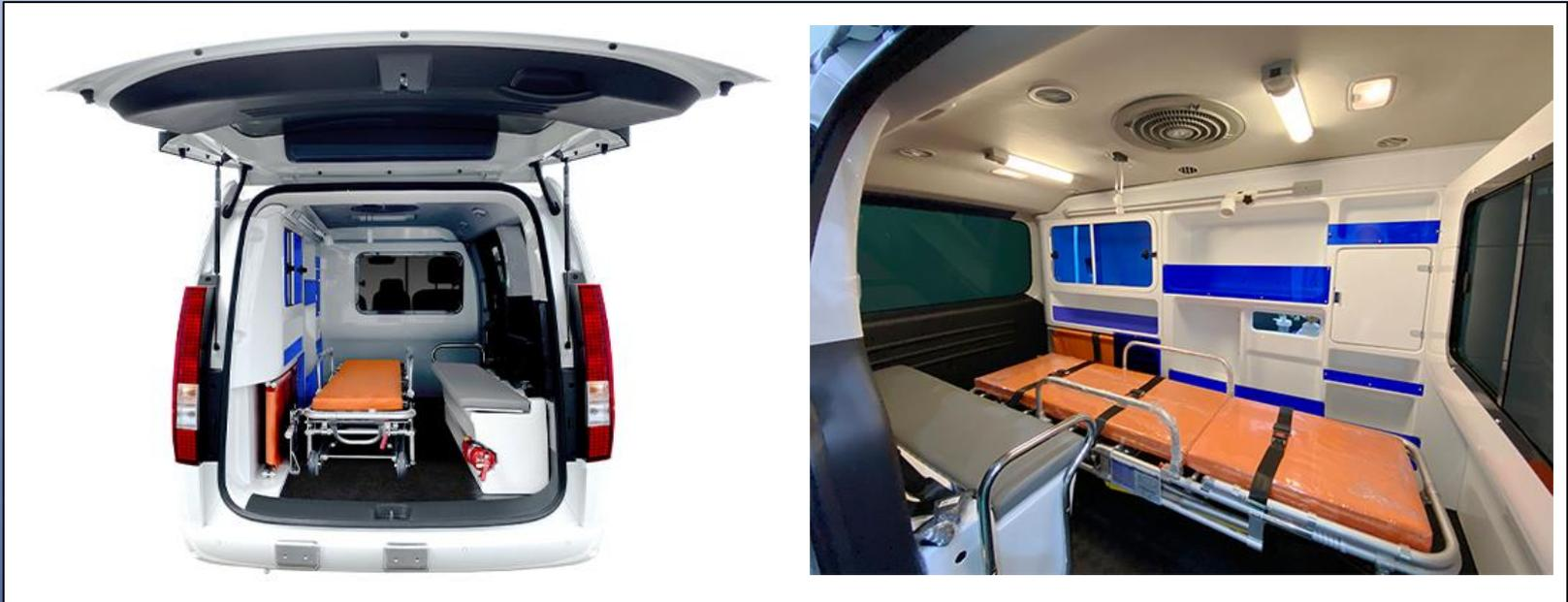
Lumière mobile, armoire intégrée, crochet IV, bouteille d'oxygène à porte à rabat, civière principale (fixe), protection de pare-chocs pour civière secondaire, ventilateur, 2 lampes de salle à LED, cloison de couverture complète, contrôleur, extincteur, banc, sièges pliants
